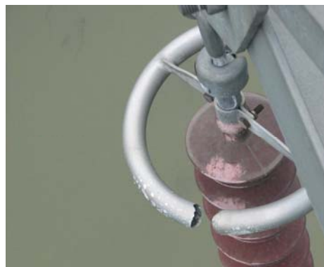
图 9 220kV 绍普线均压环雷击放电击穿图
